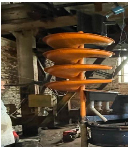
Рис 4.5 - Спіральний сепаратор типу СВШ-2-1000 з різним кутом нахилу спіралі
